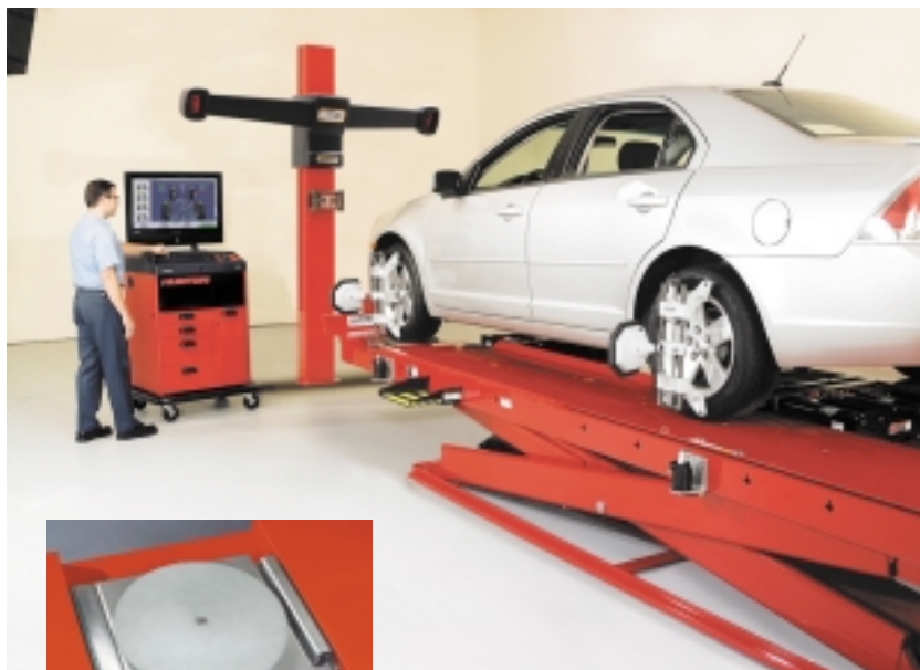
Systemy kontroli ustawienia kół. Z lewej – stacjonarny dla placówek diagnostycznych, z prawej mobilny – do uniwersalnych zastosowań
