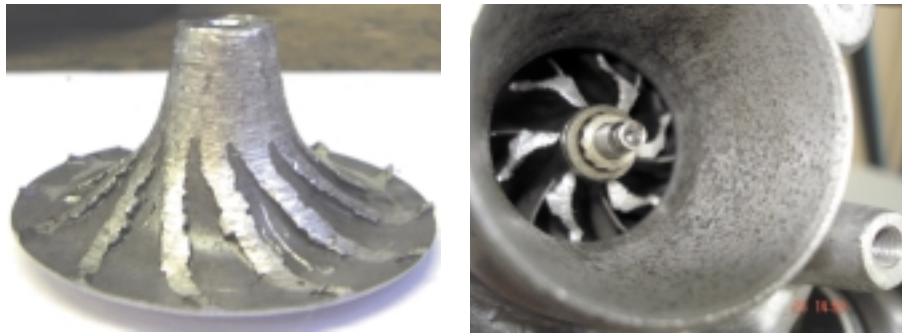
Uszkodzenia wirnika sprężarki i będące ich skutkiem zanieczyszczenie wnętrza chłodnicy powietrza
