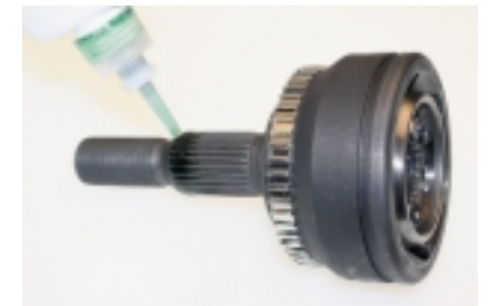
Kasowanie luzu wielowypustowych połączeń półosi
