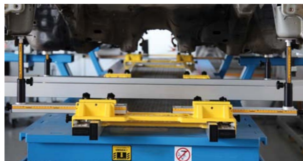
POMIARY PUNKTÓW DOLNYCH PŁYTY PODŁOGOWEJ URZĄDZENIEM MECHANICZNYM 3D. POJAZD: OPEL VECTRA 5HB (2002-2009)
