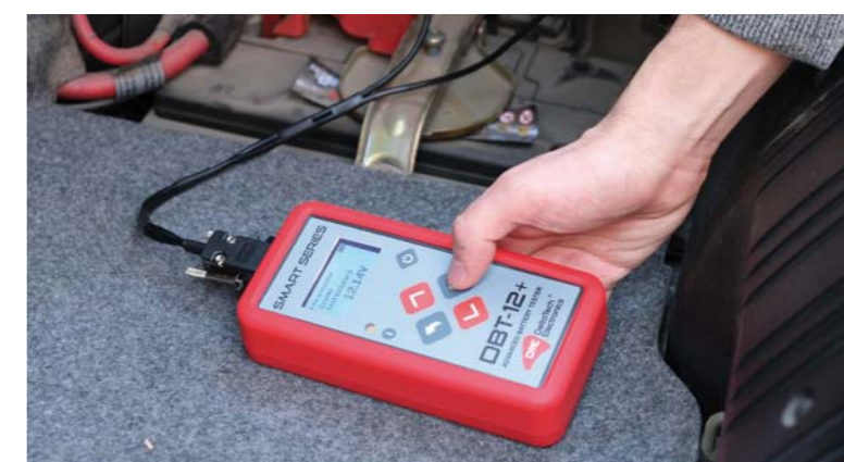
TESTER DBT-12+ UMOŻLIWI POMIAR NAPIĘCIA, STANU NAŁADOWANIA I OSZACOWANIE DOSTĘPNEGO PRĄDU ROZRUCHOWEGO
