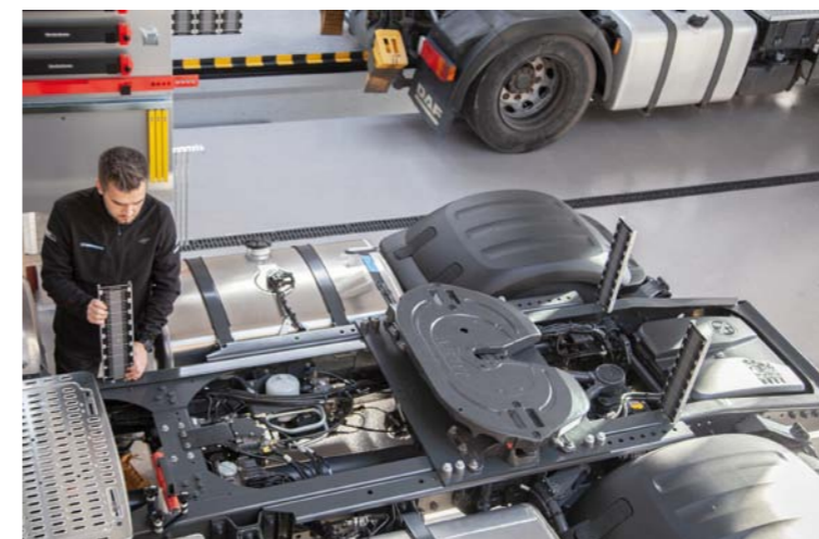
POMIAR KSZTAŁTU RAMY POJAZDU
