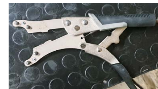
NARZĘDZIE OM 8024 MA FORMĘ SZCZYPICE MORSĘ'A, DO KTÓRYCH MONTUJE SIĘ PARY PÓLPIERŚCIEŃI DOBRANYCH WZGLĘDEM ŚREDNICY PÓŁOSI
