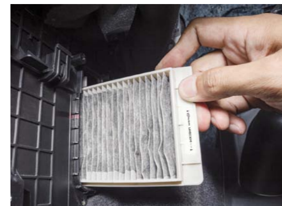
WYMIANA FILTRA KABINOWEGO JEST PROSTĄ CZYNNOŚCIĄ, CHOĆ W NIEKTÓRYCH MODELACH AUT DOSTĘP DO NIEGO MOŻE BYĆ KŁOPOTLIWY
