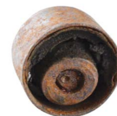
USZKODZONA TULEJA ZAWIESZENIA
