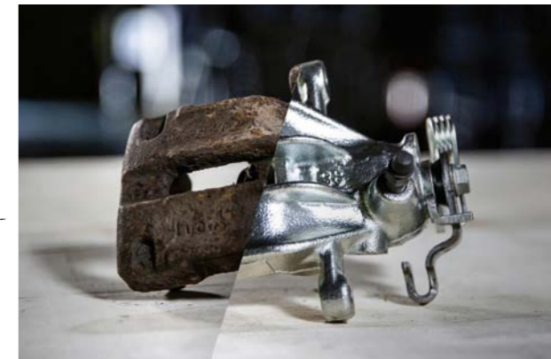
WIDOK CZĘŚCI PRZED REGENERACJĄ FABRYCZNĄ I PO JEJ PRZEPOWADZENIU
