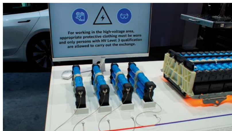
MODUŁY BATERII TRAKCYJNEJ, KTÓRE MOŻNA WYMIENIĆ ZA POMOCĄ ZESTAWU NAPRAWCZEGO FIRMY BOSCH
