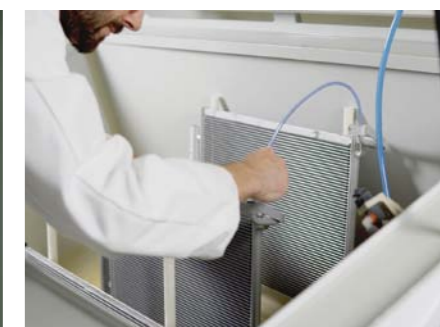
ZAAWANSOWANA PRÓBA ODPORNOŚCI NA KOROZJĘ W KOMORZE SOLNEJ SPRAWDZA ODPORNOŚĆ SKRAPLACZA NA KOROZJĘ
