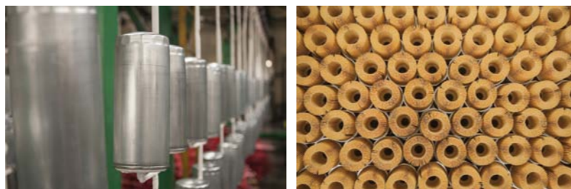
OBUDOWY FILTRÓW PUSZKOWYCH POCHODZĄ Z WŁASNEJ PRODUKCJI PZL SĘDZISZÓW, A MATERIAŁY FILTRACYJNE WYTWARZANE SĄ PRZEZ RENOMOWANYCH ZACHODNIH PRODUCENTÓW
