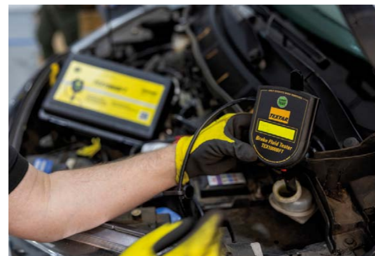
NAJLEPSZYM SPOSOBEM WERYFIKACJI STOPNIA ZUŻYCIA PŁYNU HAMULCOWEGO JEST UŻYCIE TESTERA. NA ZDJĘCIU TESTER TEX1000BFT
