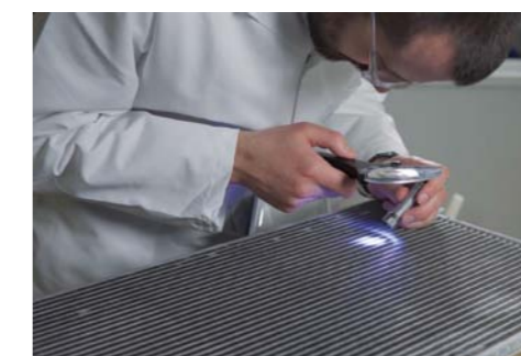
PO 400 GODZINACH TESTU KONSTRUKCJA SKRAPLACZA POZOSTAJE NIENARUSZONA. NIE STWIERDZONO OZNAK KOROZJI, A PRÓBA CIŚNIENIOWA NIE WYKAZAŁA WYCIEKÓW
